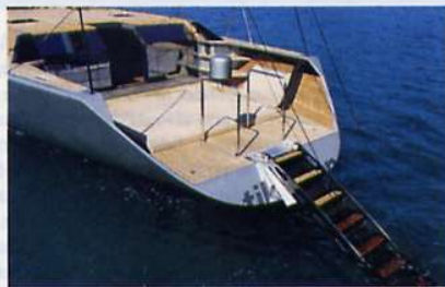
FUNZIONALE La poppa cela all'interno una passerella/scaletta realizzata in carbonio e teak.
