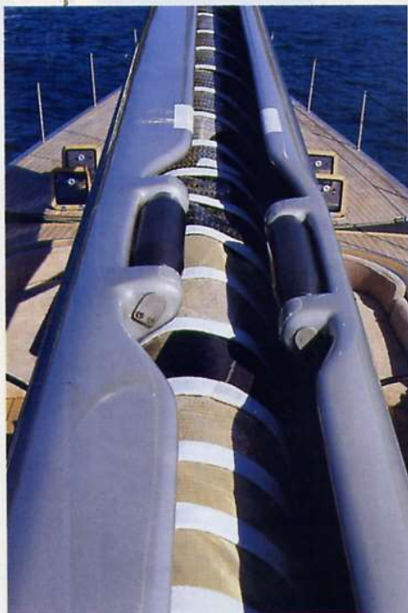
BOMA La randa del Wally Yachts 88 è avvolgibile all'interno del boma realizzato in carbonio. Le vele sono della North Sails con tessuto 3DL.
